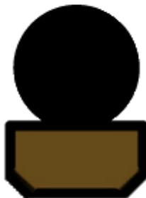
Уплотнения GIR D.E разработаны для гидравлических цилиндров двойного действия, также подходят для насосов, пресс-машин, в частности, для землеройной техники, когда расход уплотнения является значительным. Они состоят из двух частей: кольцо из материала PTFE и кольцо TECNORING. Кольцо PTFE обеспечивает превосходное уплотнение, низкое трение, высокую износостойкость и превосходную коррозионную стойкость. Кольцо TECNORING из синтетического каучука действует как уплотнительное кольцо толкателя.
